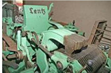
Métier à tisser Lenz HBS 3 (175 trames / minute) (1963) de la Draperies de Larochette au Musée industriel à Larochette Lenz Webstuhl HBS 3 (175 Schuss / Minute) aus Viersen von 1963 de la Draperies de Larochette im Felser Industriemuseum (Photos: 7.2.2006 jmo )
