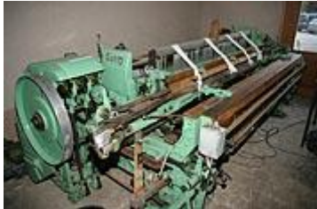
Métier à tisser Lenz HBS 3 (175 trames / minute) (1963) de la Draperies de Larochette au Musée industriel à Larochette Lenz Webstuhl HBS 3 (175 Schuss / Minute) aus Viersen von 1963 de la Draperies de Larochette im Felser Industriemuseum (Photos: 7.2.2006 jmo )
