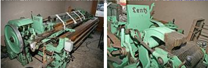
Métier à tisser Lentz HBS 3 (175 trames / minute) (1963) de la Draperies de Larochette au Musée industriel à Larochette Lentz Webstuhl HBS 3 (175 Schuss / Minute) aus Viersen von 1963 de la Draperies de Larochette im Felser Industriemuseum (Photos: 7.2.2006 jmo )
