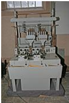
Bobinoir Hacoba (26.4.1958) de la Draperies de Larochette au Musée industriel à Larochette Hacoba Schusspulautomat (Maschinenfabrik Halstenbach + Co, Wuppertal - Barmen; Masch. No 378 -79) de la Draperies de Larochette im Felser Industriemuseum (Photos: 7.2.2006 jmo )
